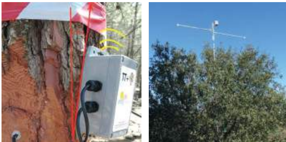
Figura 1.24. Sensores de transmitancia y reflectancia de copa: sensor TreeTalker (Nature 4.0) equipado con un sensor zenital multiespectral de 12 bandas (se instala bajo copa, en el tronco, con una inclinación entre 15 y 25° sobre la vertical del tronco) (izq.); sensor de reflectancia y NDVI y dos sensores de infrarrojos Apogee de Edaphic Scientific instalados sobre la copa de una encina (dcha.).
