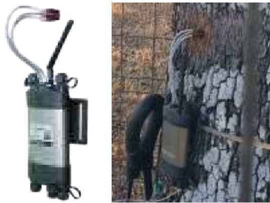
Figura 1.15. Sistema de medición flujo de savia aplicando método de pulso de calor: sensor SFM1 de ICT International Ltd. (ver especificaciones en la Tabla 1.5).
