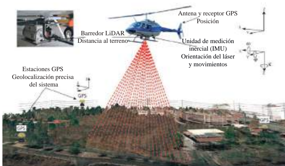
Figura 10.1. Elementos de un sistema LiDAR Aerotransportado ( Airborne Laser Scanner, ALS ): sistema de Posicionamiento Global (GPS), unidad de medición inercial (IMU), sensor LiDAR, reloj de temporización y computadora (Peralta Higuera y Ramírez Beltrán, 2016).
