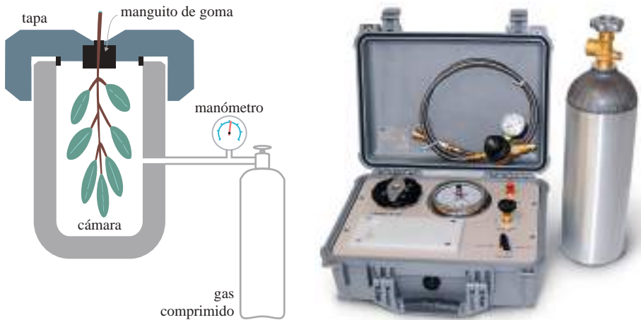
Figura 1.18. Esquema de una bomba de Scholander (izq.); cámara modelo SEC-3115P40G4V22 de ICT International (dcha.) (ver especificaciones en la tabla 1.6).
