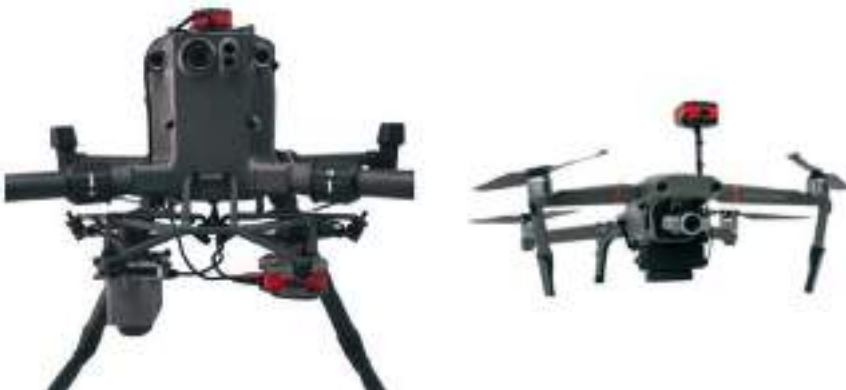
Figura 18.5. Soporte multisensor para DJI Matrice 200 (izq.) y soporte sensor multispectral para DJI Mavic 2 (der.).
