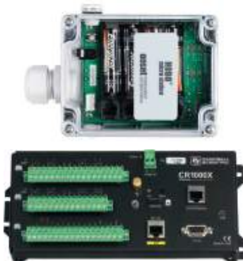
Figura 1.6. Ejemplos de sistemas colectores: transductores inteligentes que reconocen la señal de algún sensor y se autoprograman (ej., estación meteorológica HOB0 Micro Station Data Logger (sup.)) y colectores independientes que recogen a través de puertos de datos la información con respecto a la señal eléctrica, la tasa de adquisición y almacenamiento del dato (ej., colector de datos CR1000X de Campbell Scientific Inc.(inf.)).
