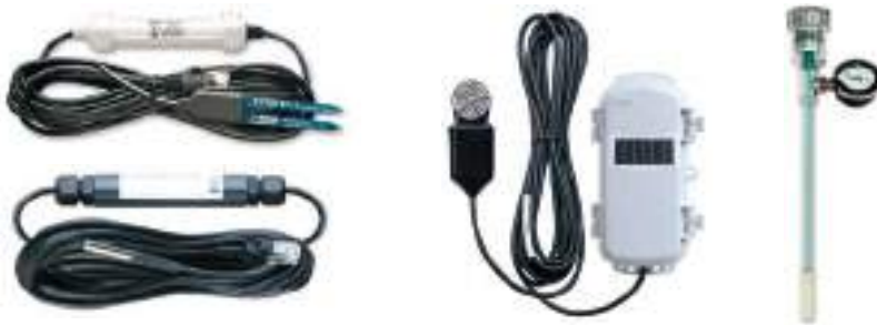
Figura 1.14. Ejemplos de sensores de variables de estado de energía del suelo: sensores HOBO de contenido volumétrico de agua (S-SMC-M005) (sup. izq.) y de temperatura del suelo (S-TMB-M002) (inf. izq.), que se conectan al data logger mediante un puerto USB; sensor inalámbrico HOBO RXW TEROS 21 de potencial de agua en el suelo y temperatura; tensiómetro 64xx series de SpectrumTechnologies (dcha.) (ver especificaciones técnicas en la Tabla 1.4).
