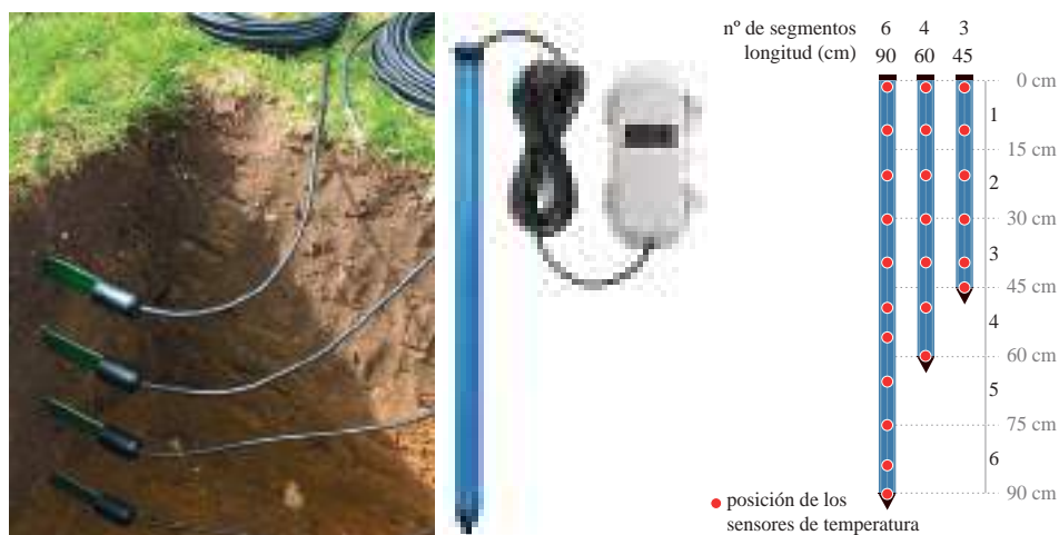
Figura 1.23. Soluciones para recoger la variabilidad vertical de las características de suelo: instalación de sensores de humedad de suelo a varias profundidades (izq.); sensor capacitivo multiprofundidad RXW-GPxA de HOBONet (centro) y número de segmentos y profundidad de medición de los modelos disponibles (dcha.).
