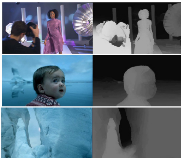
Figura 1.2 – Par de imagens a serem exibidas nos monitores da linha WOWvx da Philips, lançada em 2008: a) Imagem Bidimensional e b) Mapa de Profundidade da imagem. O hardware do monitor realiza os cálculos a partir do mapa de profundidade e exibe a imagem tridimensionalmente
