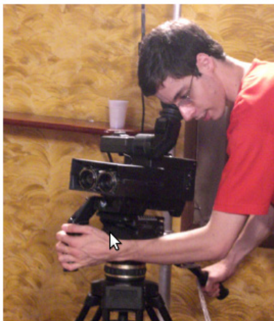
Figura 1.1 – Câmera estereoscópica digital em operação. A câmera possui dois blocos óticos de captação de imagem na câmera, afastados 6,5 cm (simulando a visão humana)
