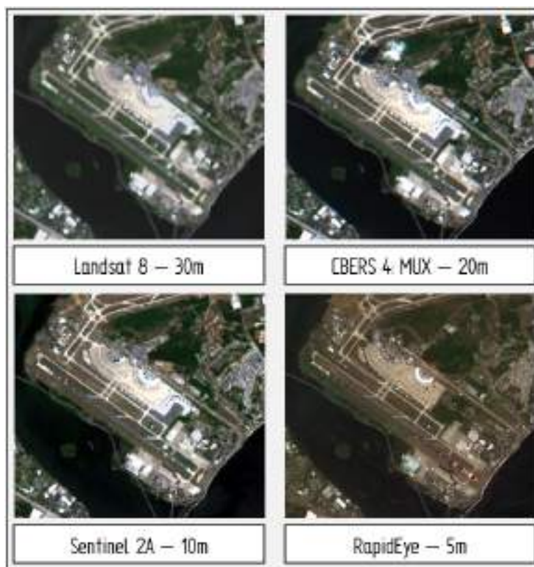
Figura 17 - Representação matricial ( raster ) e comparação entre diferentes sensores
