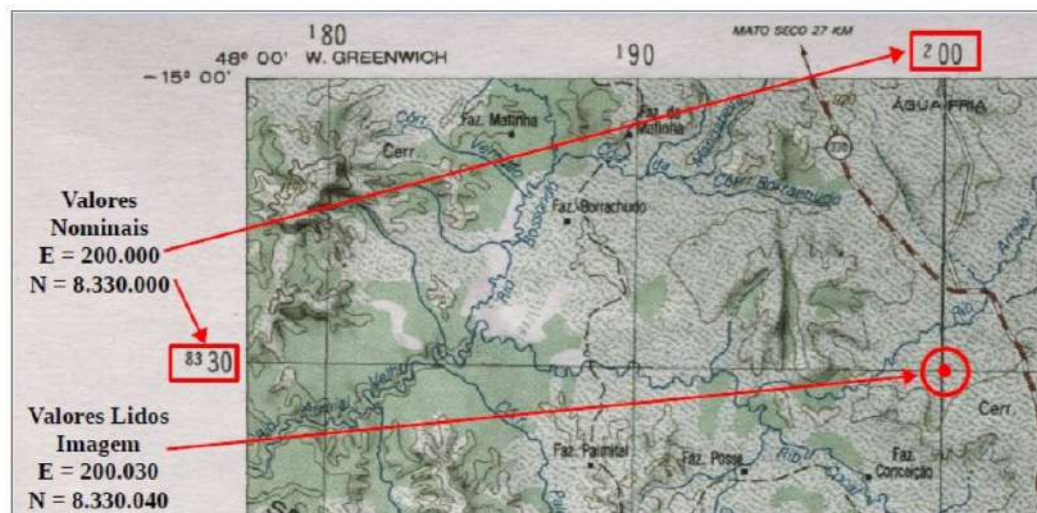
FIGURA 11 – UTILIZAÇÃO DA GRADE DE COORDENADAS COMO PONTOS DE CONTROLE
