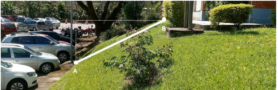
FIGURA 23 – REPRESENTAÇÃO DA DISTÂNCIA INCLINADA
