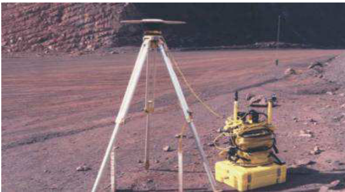
Receptor móvel preparado para medir escavação da boca de um túnel
