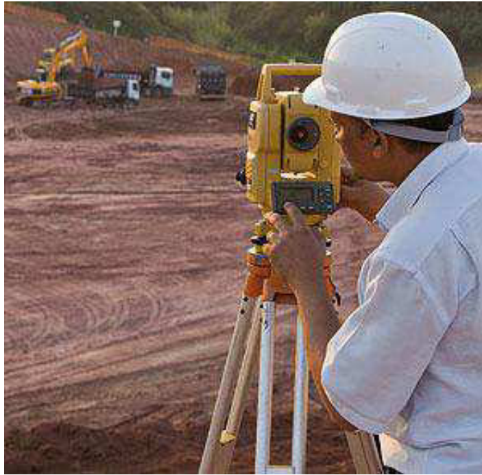
Técnico em mineração utilizando teodolito em mina.
