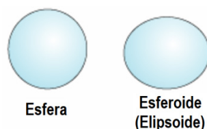
FIGURA 9 – REPRESENTA-SE A TERRA COMO UM ELIPSOIDE, MAS NÃO COMO UMA ESFERA, DEVIDO À IRREGULARIDADE DA DISTRIBUIÇÃO DA SUA MASSA
